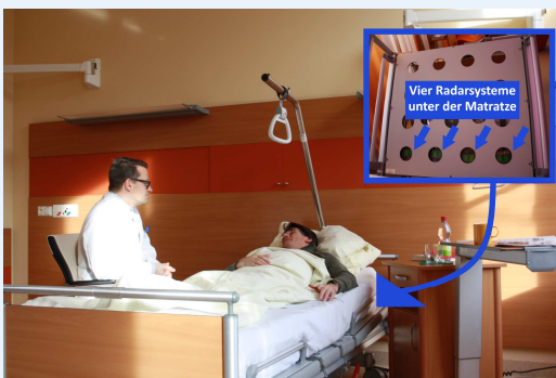
Abb.1 Unter der Matratze ist nicht sichtbar eine Radarbank mit vier Hochfrequenzmodulen verbaut. Die Erfassung findet kontinuierlich, durch Matratze und Bekleidung hindurch und von unten statt. Am Rücken sowie an der Flanke der Patientenprobanden kann RBM Atemexkursion, Pulswelle und Herzöne erfassen.
